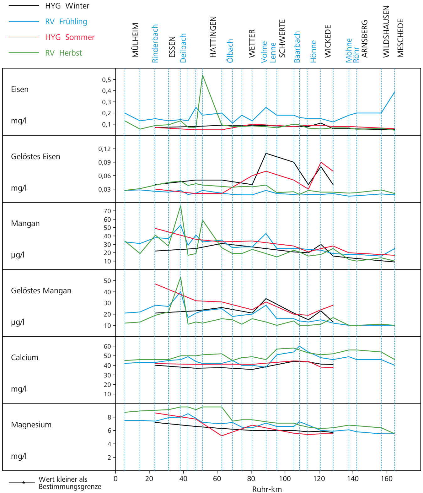
Bild 20.5: Die Wasserbeschaffenheit der Ruhr nach Analysen des AWWR-Ausschusses „Wassergüte“ Fig. 20.5: Water condition of the Ruhr according to analyses of the AWWR water quality committee
