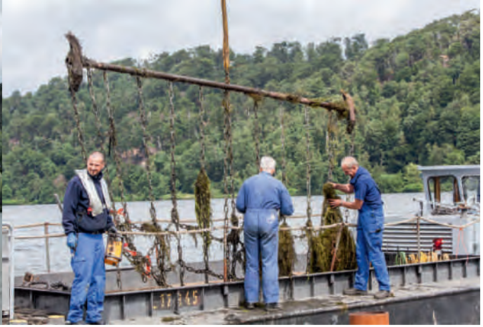
Bild 6.44: Versuche zur mechanischen Reduktion von Elodea-Beständen im Baldeneysee am 8. Juli 2015. Links: Schleppsense, rechts: Polterkette Fig. 6.44: Trials for the mechanical reduction of Elodea in Lake Baldeney on 8 July 2015. Left: trailing knife unit, right: dredging chain
