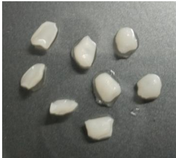
Bild 4-5: Transgene Hefezellen immobilisiert in einem Gel aus Polyvinylalkohol, sogenannte Lentikat-Linsen
