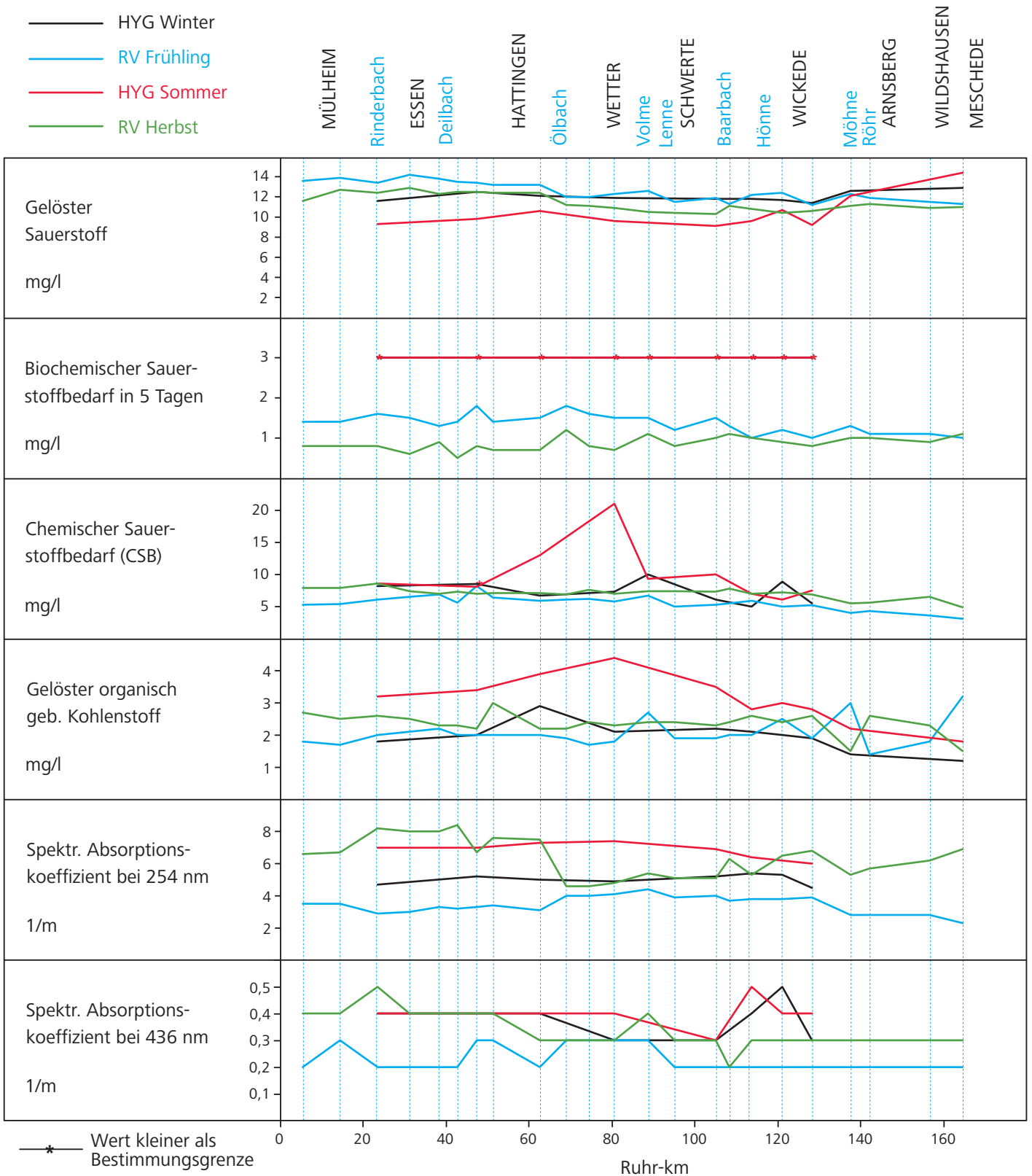
Bild 21.2: Die Wasserbeschaffenheit der Ruhr nach Analysen des AWWR-Ausschusses „Wassergüte“ Fig. 21.2: Water condition of the Ruhr according to analyses of the AWWR water quality committee
