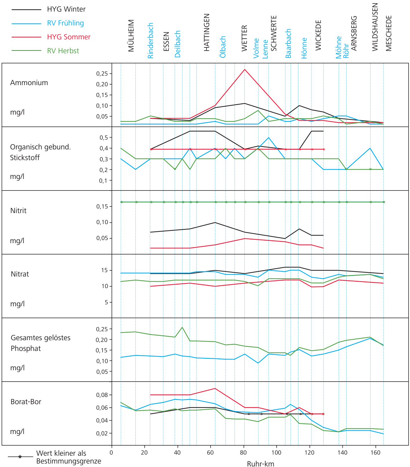
Bild 21.3: Die Wasserbeschaffenheit der Ruhr nach Analysen des AWWR-Ausschusses „Wassergüte“ Fig. 21.3: Water condition of the Ruhr according to analyses of the AWWR water quality committee
