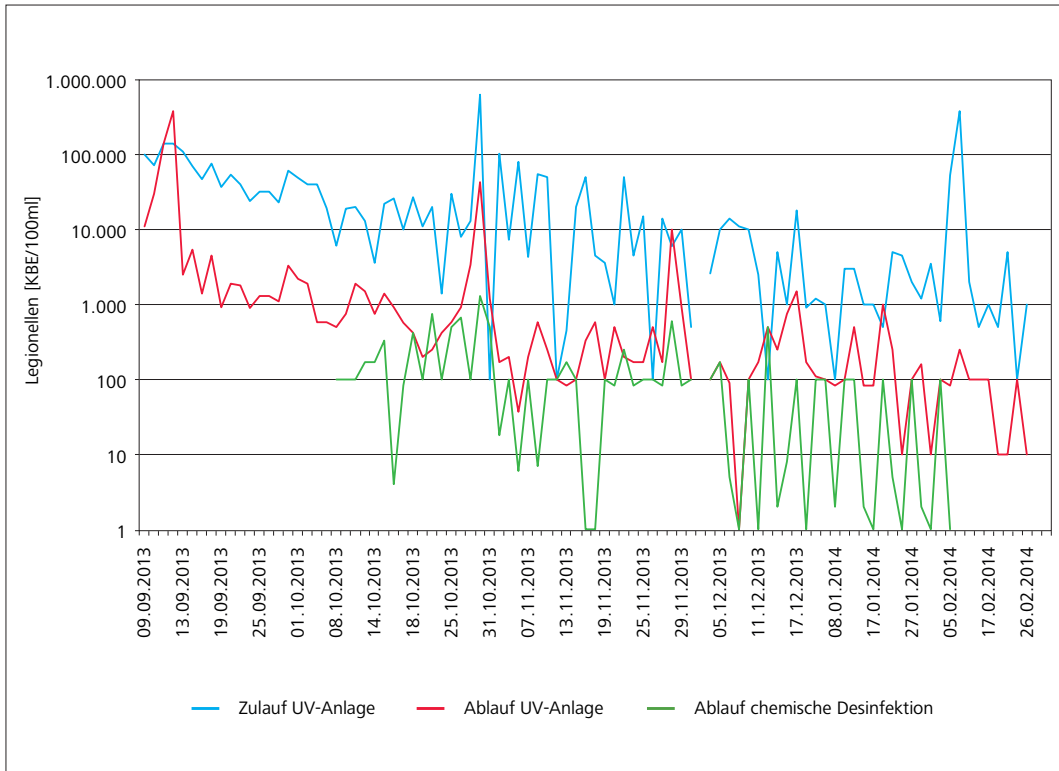
Bild 7.6: Kläranlage Warstein – Zeitliche Entwicklung der Legionellenzahlen im Ablauf der Nachklärung (Zulauf UV-Anlage) und der Desinfektionsstufen
