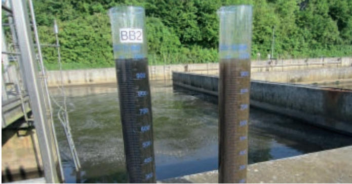
Bild 10.1: Belebter Schlamm der KA Schwerte, links: Versuchsstraße (Straße 2) bei Betrieb der „dynamischen Rezirkulation“ mit Pulveraktivkohle („Rezi-PAK“), dadurch deutliche Verfärbung, rechts: Referenzstraße (Straße 1) mit konventionellem Betrieb
