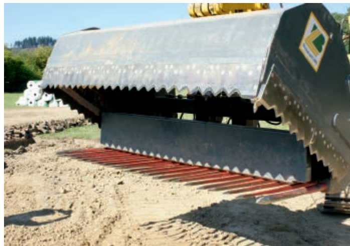
Bild 17.14: Grassodenstechgerät Fig. 17.14: Grass stitcher
