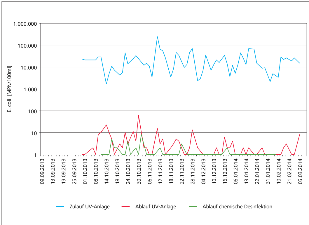
Bild 7.7: Kläranlage Warstein – Zeitliche Entwicklung der Zahl an E. coli im Ablauf der Nachklärung (Zulauf UV-Anlage) und der Desinfektionsstufen
