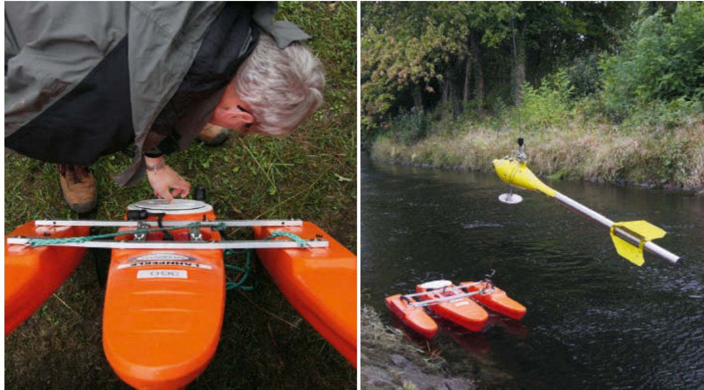
Abflussmessung mit einem ADCP-Messgerät während des Anwendertreffens am Pegel Günne/Möhne. Discharge measurement using a ADCP device during the users' meeting at the Günne/Möhne gauging station.
