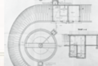
Kläranlage Mülheim - Forst Nachklärbecken und Geräte- u. Maschinenraum M. 1:50 Jahrb. 4-5
