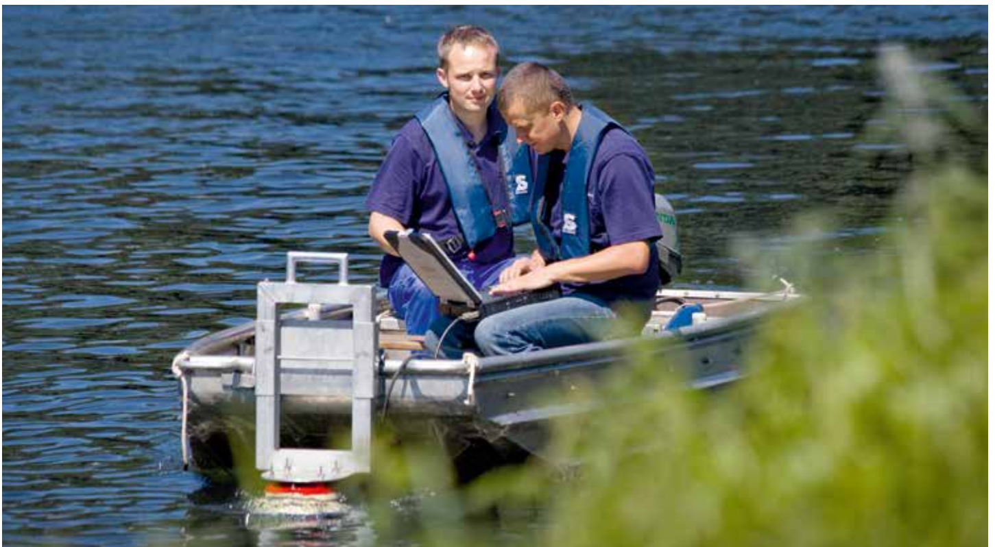
Profilaufnahme mit einem ADCP-Messgerät am Pegel Herdecke/Ruhr (Zulauf Harkortsee) Profiling using an ADCP device at the Herdecke/Ruhr gauging station
