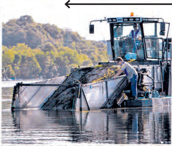
Das Mähboot des Ruhrverbandes soll noch in diesem Monat auf dem Baldeneysee zum Einsatz kommen, um den Wildwuchs der Wasserpest einzudämmen. Bei Bedarf ordert die Stadt ein zweites Boot. Foto: Walter Buschert
